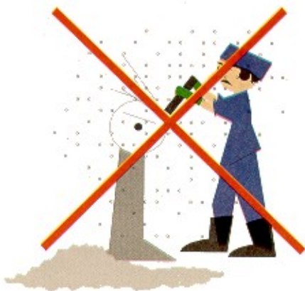
Figura 49A - Limpeza de peça sem exaustão liberando poeira de material pesado
