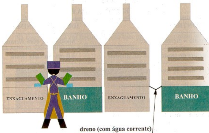
Figura 44 - Esquema para exaustão lateral
