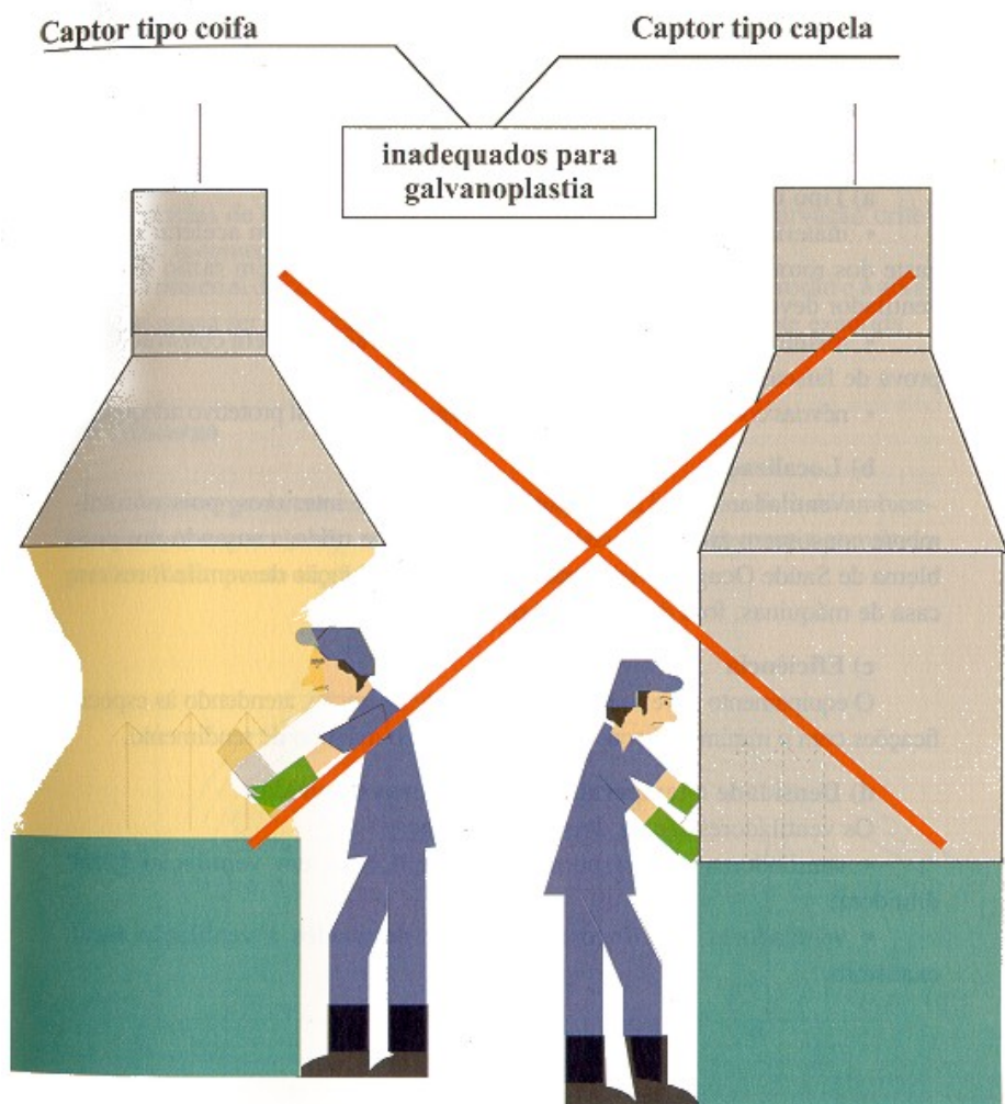
Figura 11 - Captadores tipo coifa e capela
