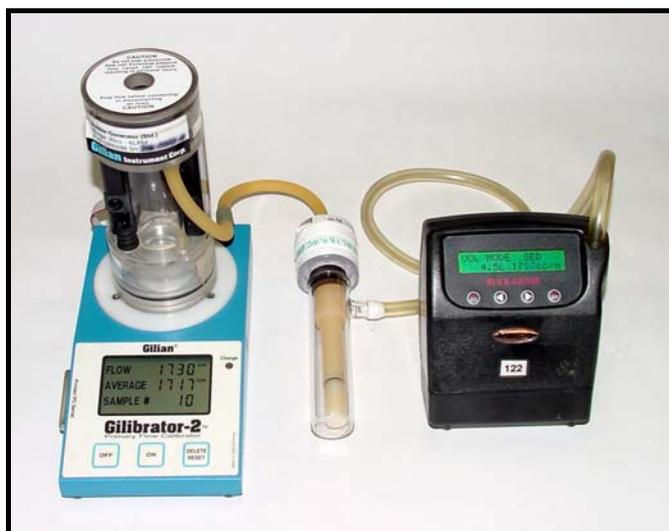
Figura 18- Sistema de calibração da vazão da bomba de amostragem.
