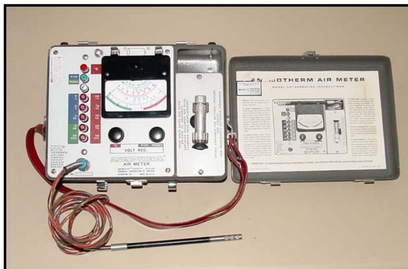
Figura 20- Termoanemômetro Anemotherm.
