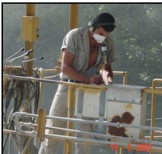
Figura 21- Conjunto amostrador posicionado na zona respiratória do operador do britador.
