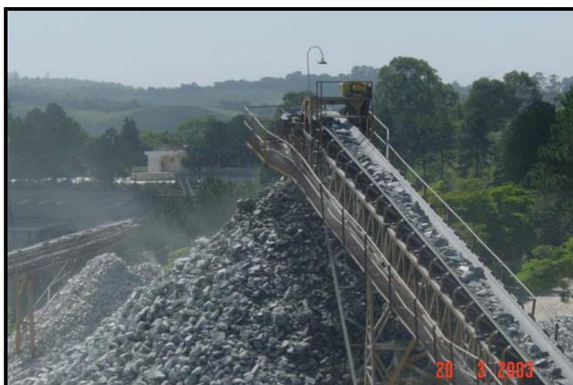
Figura 9- Correia transportadora do britador.
