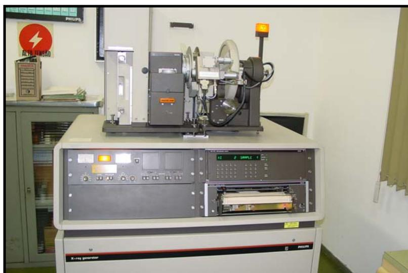
Figura 17- Difratômetro de raios-X.
