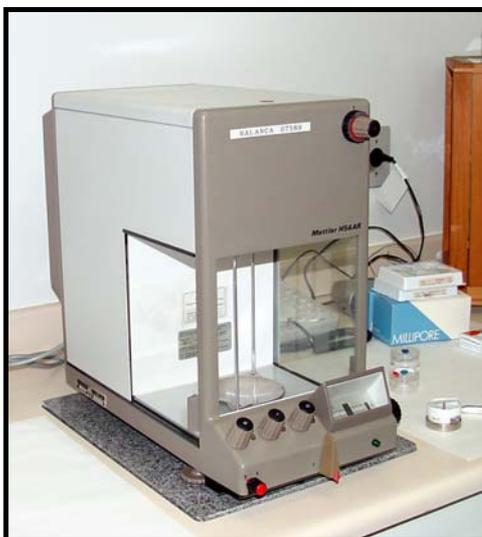
Figura 16- Balança analítica de precisão.
