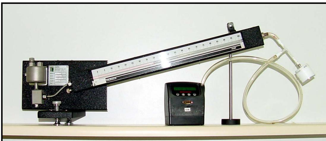
Figura 15- Sistema de medição da perda de carga no porta-filtro com manômetro de coluna inclinada.
