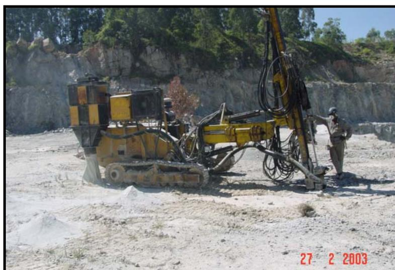
Figura 3- Carreta de perfuração hidráulica provida de sistema de ventilação local exaustora.
