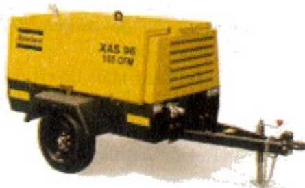
Figura 31 Compressores com tratamento acústico.
