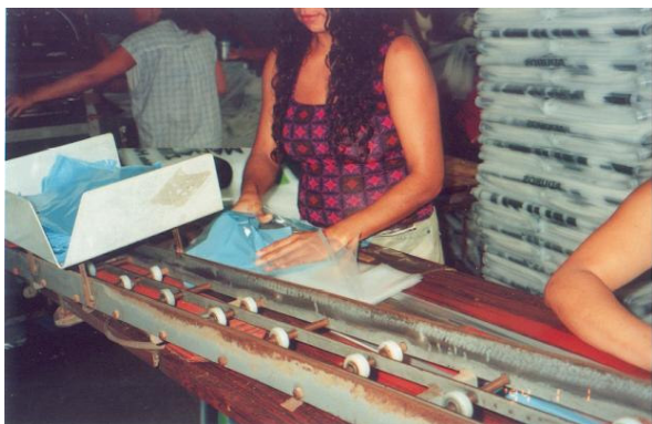
Figura 3: Realização da moldagem de embalagem no setor de valvulado
