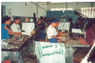
Figura 3: Posto de trabalho no qual “puxa-se” a embalagem sob a máquina.
