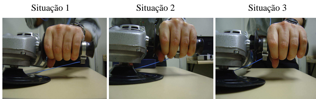
Figura 29: Posicionamentos do acelerômetro no punho auxiliar
