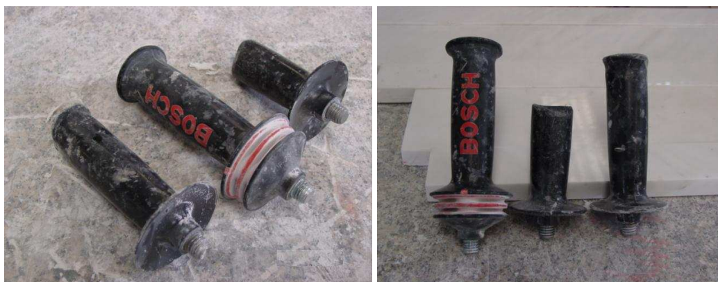
Figura 17: Tipos e condições de punhos auxiliares de lixadeiras
