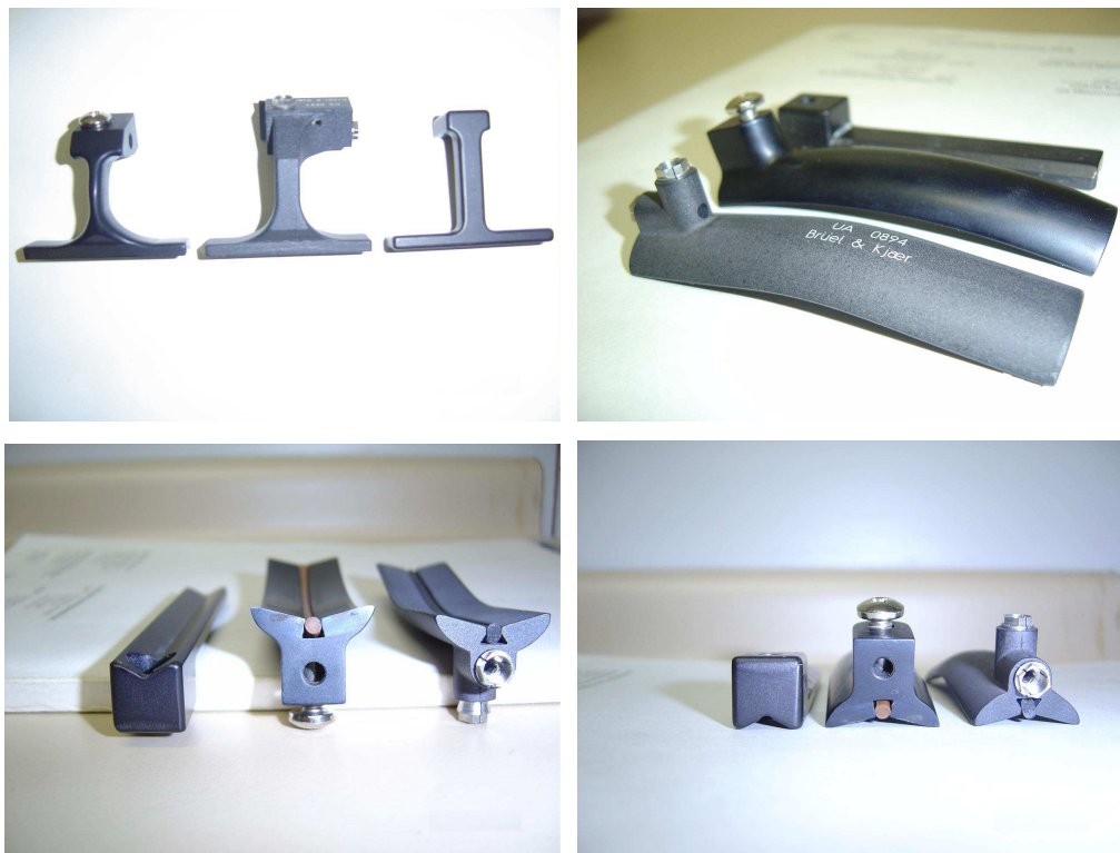
Figura 13: Detalhes dos adaptadores para mãos e punhos
