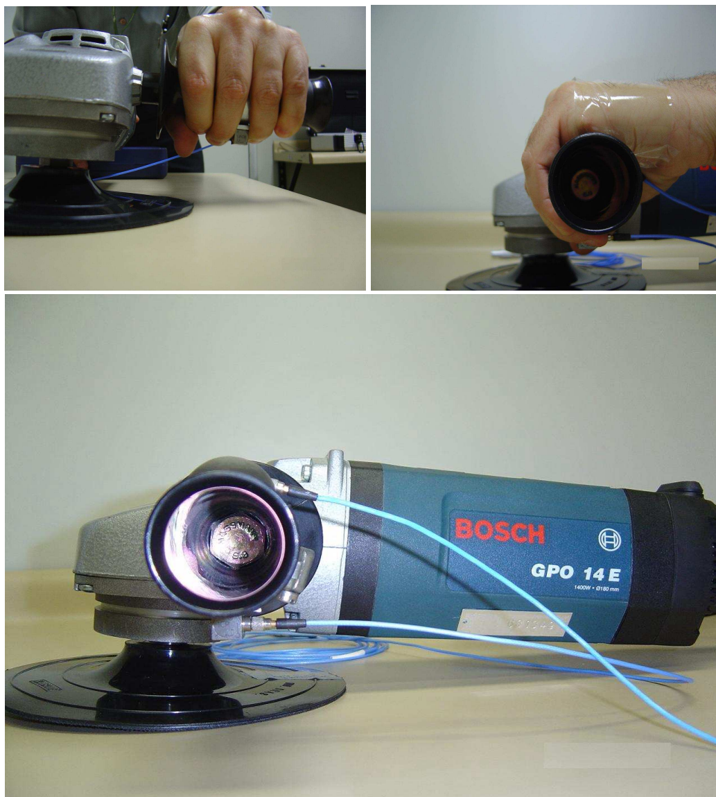
Figura 21: Montagens sobrepostas com dois acelerômetros triaxiais
