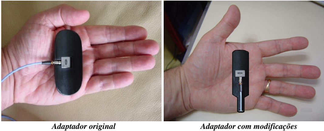
Figura 31: Proposição de modificações no adaptador de palma
