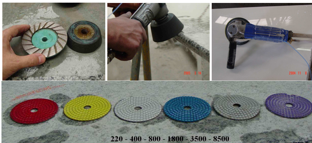
Figura 14: Exemplo de acessórios utilizados em ferramentas com processo à água, para as operações de desbaste, acabamento fino e lustro.
