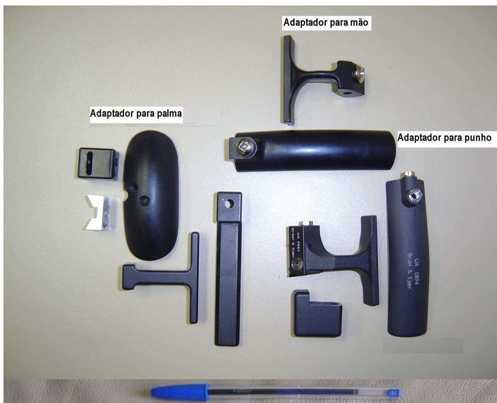
Figura 12: Principais tipos de adaptadores disponibilizados por vários fabricantes
