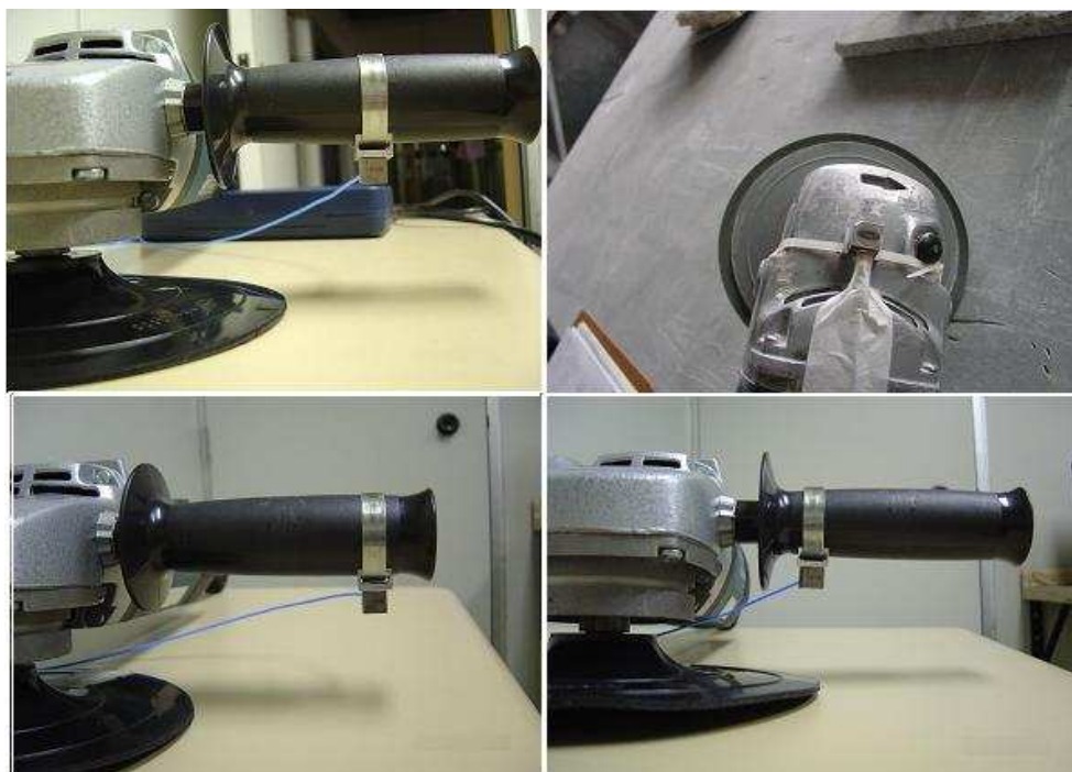
Figura 15: Montagens dos acelerômetros com abraçadeira
