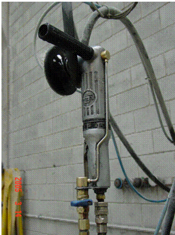
Figura 13.4 – Ferramenta manual para acabamento de bordas a úmido – Politriz manual com funcionamento pneumático Fonte: Com autorização do autor, Irlon Ângelo da Cunha
