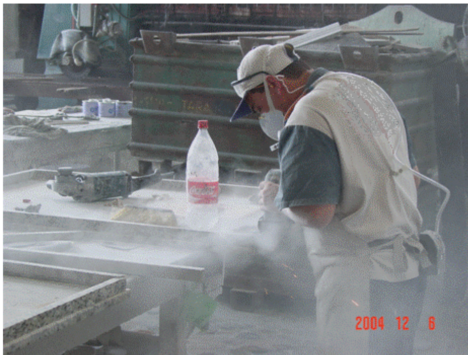
Figura 5.14 – Atividade de desbaste com politriz manual e rebolo para processo com a etapa de acabamento a seco em marmorarias. Município de São Paulo, 2003-2005
