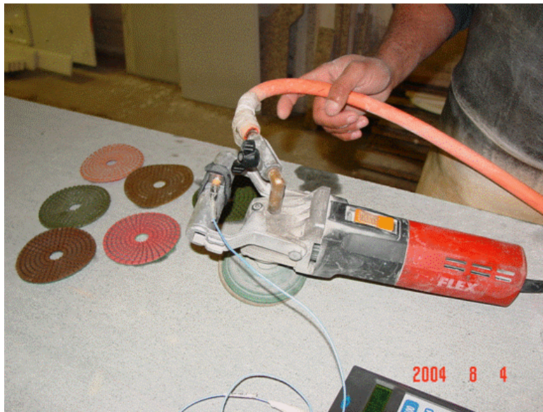
Figura 13.3 – Ferramenta manual para acabamento de bordas a úmido – Politriz manual com funcionamento elétrico Fonte: Com autorização do autor, Irlon Ângelo da Cunha
