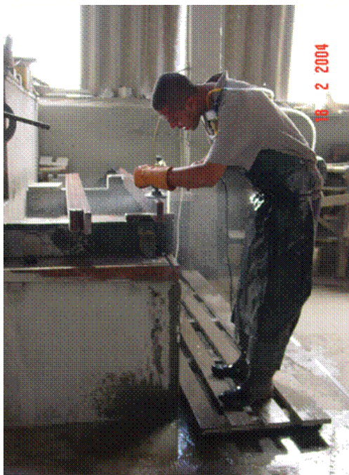
Figura 5.17 – Atividade de desbaste com politriz manual e disco diamantado para processo com a etapa de acabamento a úmido em marmorarias. Município de São Paulo, 2003-2005
