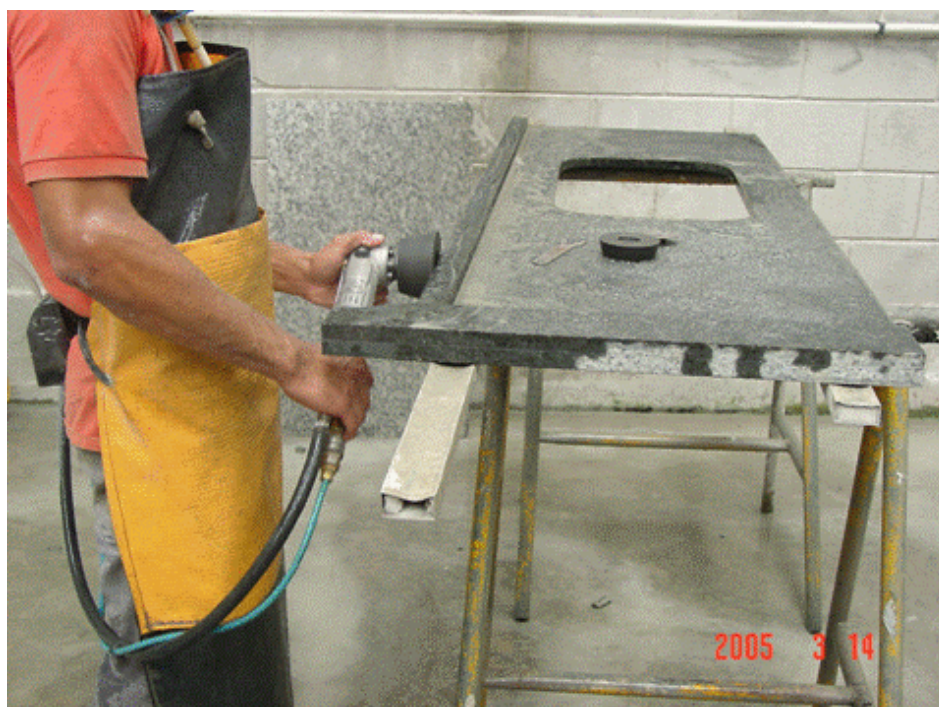
Figura 5.15 – Atividade de desbaste com politriz manual e rebolo para processo com a etapa de acabamento a úmido em marmorarias. Município de São Paulo, 2003-2005
