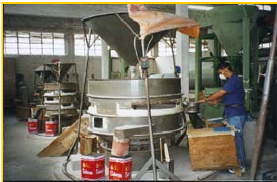
Figura 5.1 Vista geral da descarga das peneiras classificadoras
