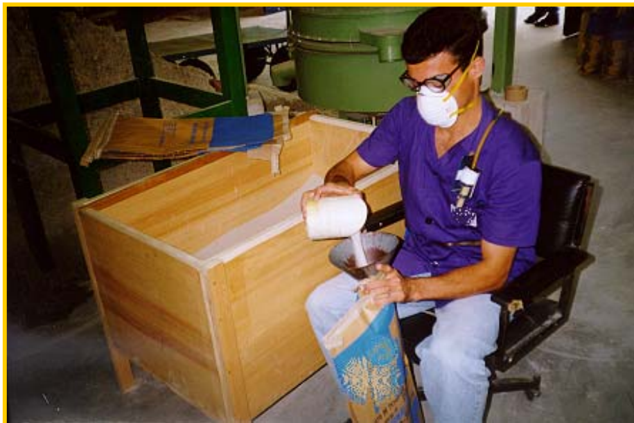
Figura 5.2 Ensacamento da areia classificada
